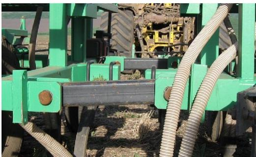
Рисунок 5 – Соединительное устройство для соединения машин «Обь-43Т» в агрегате
