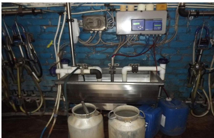
Рисунок 4 – Общий вид автомата промывки Aquarus 50
