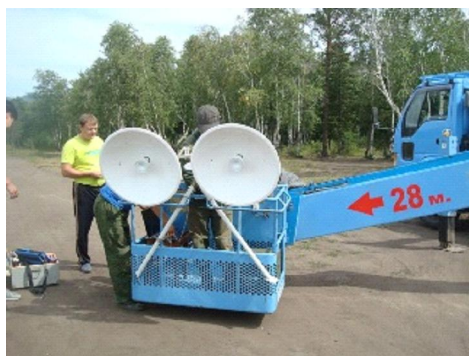
Рисунок 3 – Установка наносекундного радара на высотный подъемник
