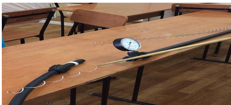
Рисунок 4 – Установка завихрителя в трубопровод
