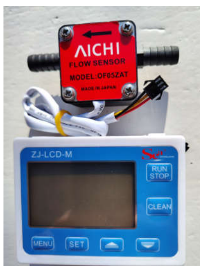
Рисунок 2. Общий вид контроллера расхода топлива J-LCD-M с сенсором US211M модели OF 052AT
