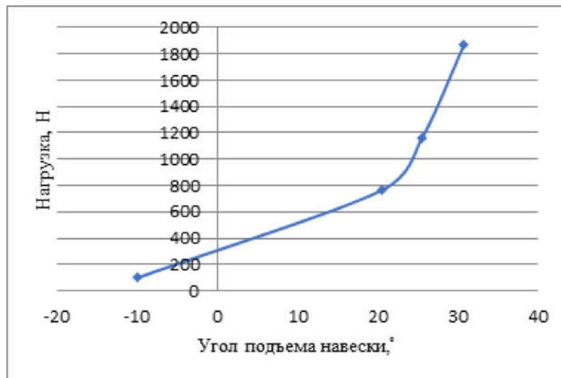
Рисунок 3. Зависимость величины нагрузки в гибкой тросовой связи устройства при увеличении угла подъема навески (передача сцепного веса с трактора на борону)
