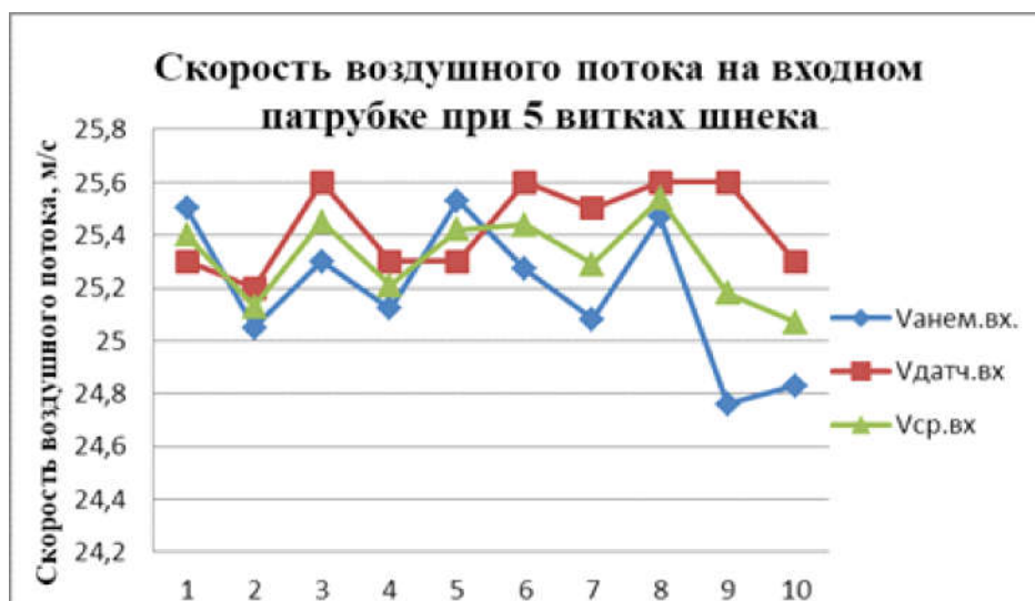
Рисунок 9. Скорость воздушного потока на выходном патрубке при 5 витках шнека
