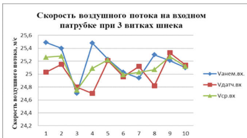
Рисунок 5. Скорость воздушного потока на входном патрубке при 3 витках шнека
