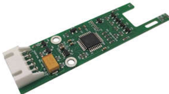
Рисунок 3. Анемометр CG Anem
