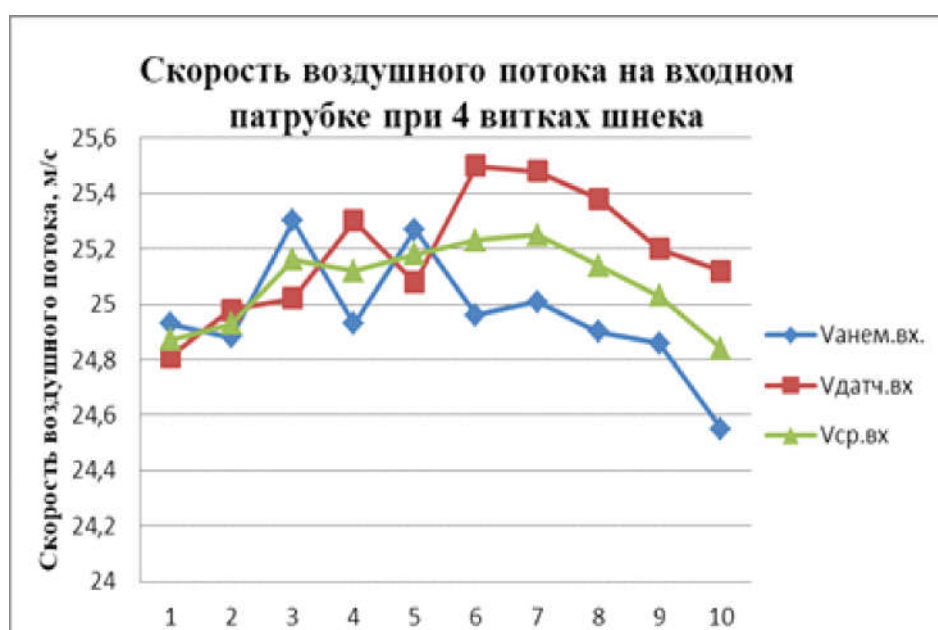
Рисунок 7. Скорость воздушного потока на выходном патрубке при 4 витках шнека
