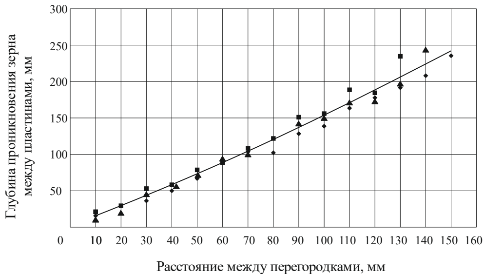
Рисунок 11. Зависимость глубины проникновения зерна пшеницы между перегородками от расстояния между ними при горизонтальном расположении перегородок
