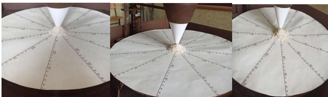
Рисунок 3. Результаты проведения эксперимента на приборе для определения коэффициента и угла внутреннего трения в зависимости от абсолютной влажности ВУА. Примечание. А – влажность W_a = 11\% ; Б – влажность W_a = 17\% ; В – влажность W_a = 23\%
