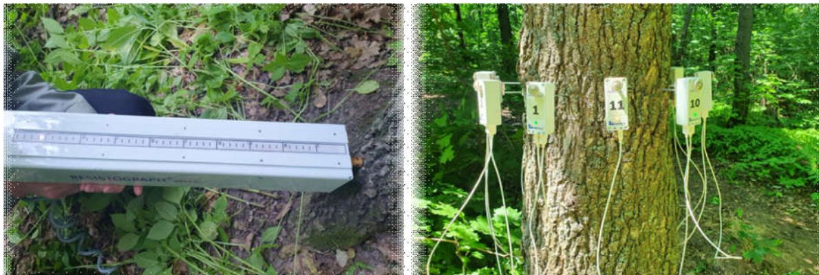
Рисунок 1. Измерение внутреннего состояния древесины Quercus robur L. при использовании Resistograph® 4452-S и импульсного томографа «Арботом®»
