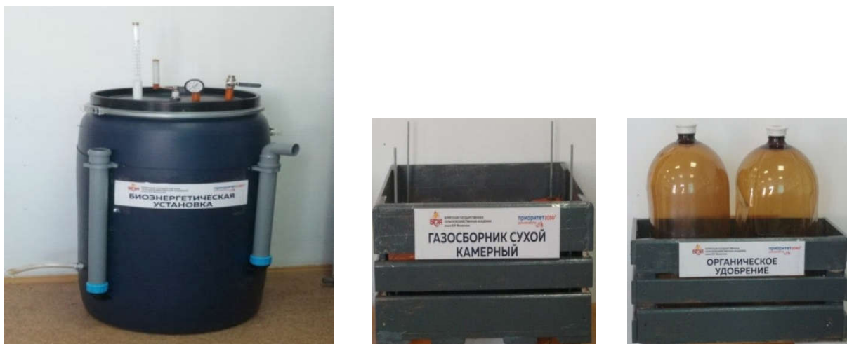
Рисунок 1. Общий вид биоэнергетической установки БЭУ-С: а) метантенк, б) сухой камерный газосборник и в) сборник удобрений.
