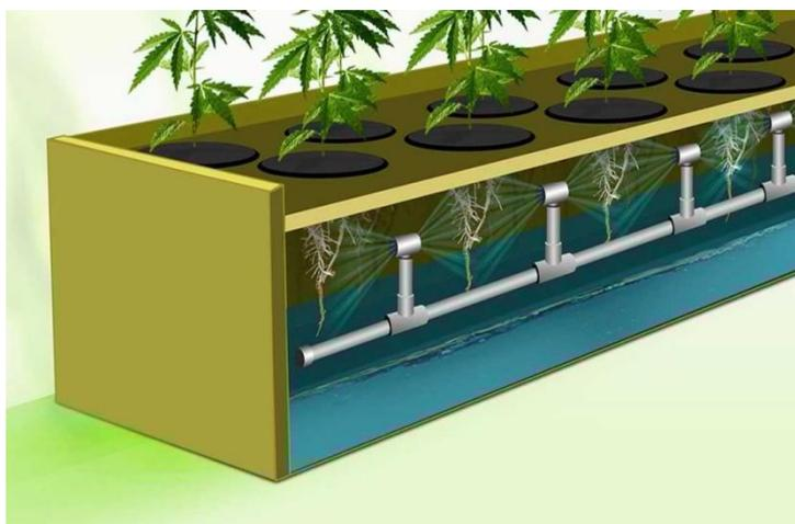
Рисунок 1 - Аэропонная установка.
