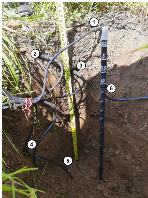
Рисунок 2 - Размещение датчиков SMAT-meter в грунте: цифрами 1, 2, 3, 4, 5 указаны датчики влажности почвы, цифрой 6 — температурный зонд
