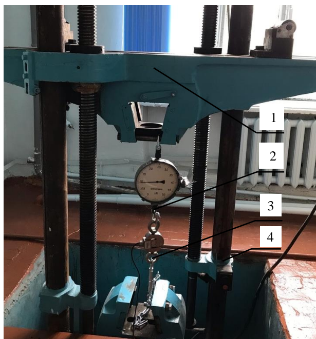
Рисунок 7 - Общий вид лабораторной установки: 1 – подвижная балка; 2 – образцовый динамометр; 3 – S-образный тензорезисторный датчик; 4 – неподвижное основание.
