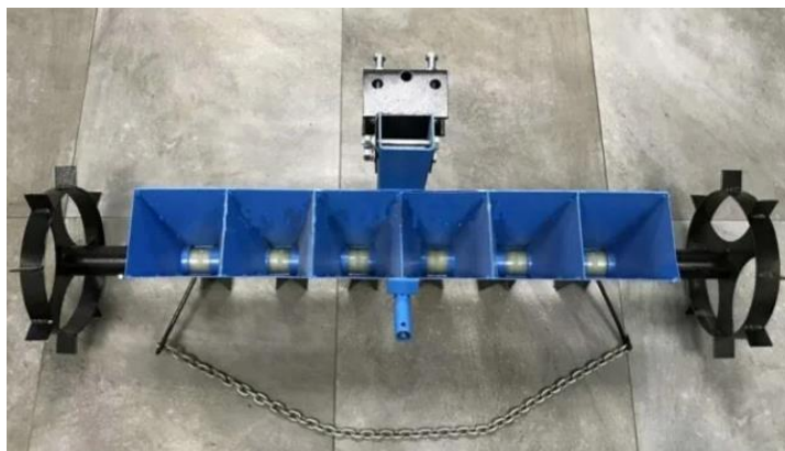
Рисунок 5 –сеялка Пахарь СМ-6
