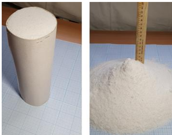
Рисунок 2 – Определение угла естественного откоса твердого сыпучего консерванта – бензойной кислоты
