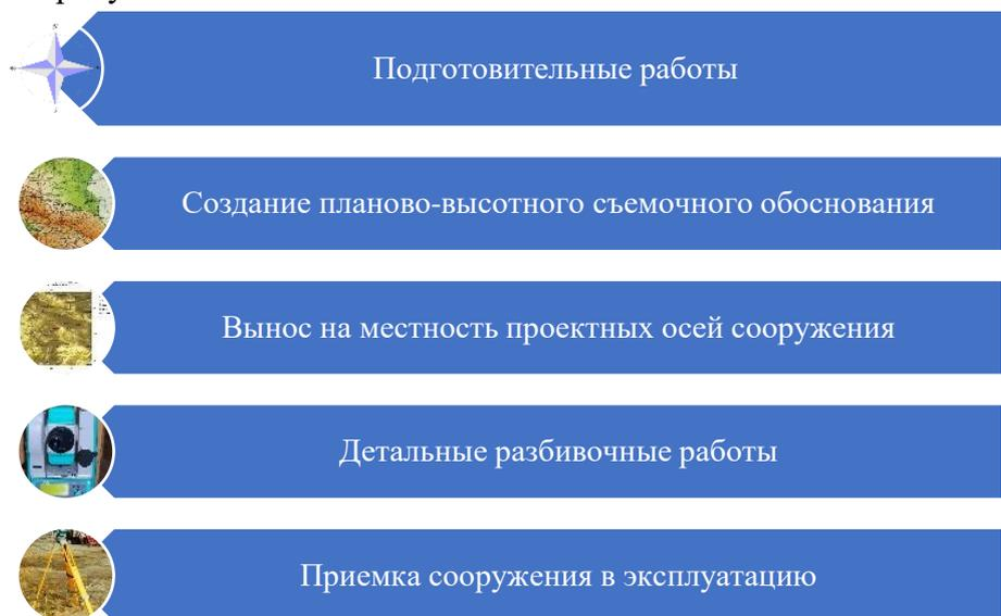
Рисунок 8 – Последовательность выполнения работ
