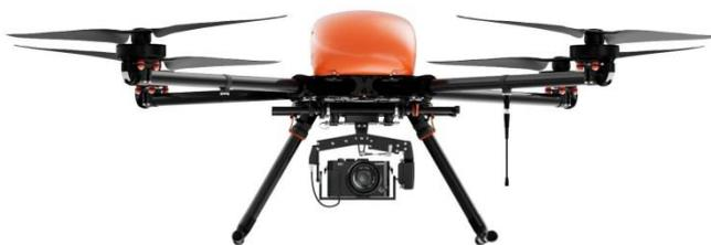
Рисунок 3 – Квадрокоптер для аэрофотосъемки Геоскан-401 Геодезия
