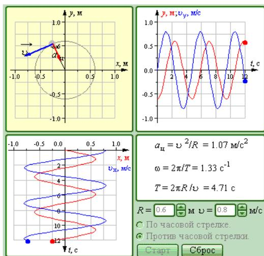
**Задача 2. Равномерное движение по окружности.** Определите центростремительное ускорение, круговую частоту и период вращения тела по окружности радиуса  $0,8$  м со скоростью  $0,7$  м/с (см. рис. выше).
