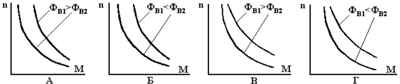
25.3. Показать механические характеристики ДПТ независимого возбуждения при торможении противовключением;
