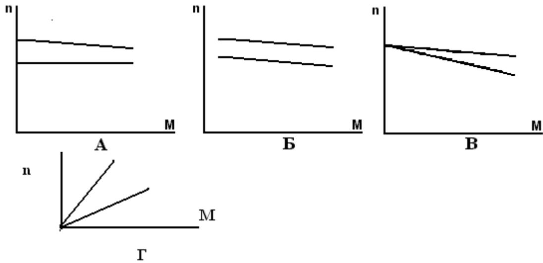
25.4. Показать механические характеристики ДПТ независимого возбуждения при разных сопротивлениях цепи якоря;
