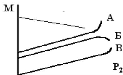
11.1. Показать механическую характеристику АД при ( $M_c = \text{const}$ )  $2P' > 2P$
