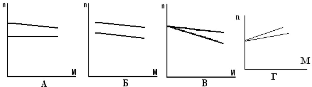
30.2. Какой тип двигателя постоянного тока нельзя подключать к напряжению без механической нагрузки?
