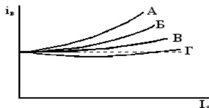
25.1. Показать регулировочные характеристики ГПТ параллельного возбуждения;
