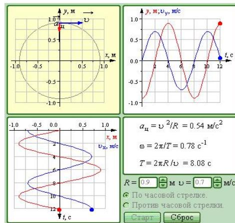
**Задача 2. Равномерное движение по окружности.** Определите центростремительное ускорение, круговую частоту и период вращения тела по окружности радиуса 0,5 м со скоростью 1,2 м/с (см. рисунок выше).
