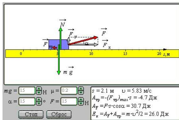
**Задача 2. Механическая работа.** На брускок массой 11 кг действует внешняя сила 450 Н под углом  $25^\circ$ . Коэффициент трения о плоскость 0,2. Определите работу внешней силы после прохождения пути 15 м. Убедитесь в компьютерном эксперименте, что сумма работ силы трения и внешней силы равна кинетической энергии бруска (см. рисунок выше).
