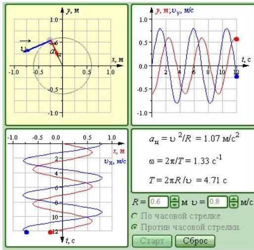
**Задача 2. Равномерное движение по окружности.** Определите центростремительное ускорение, круговую частоту и период вращения тела по окружности радиуса 0,8 м со скоростью 0,7 м/с (см. рис. выше).
