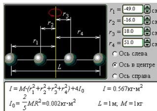
**Задача 4. Момент инерции твердого тела.** Для оси вращения, проходящей через конец спицы, и следующего расположения шаров:  $r_1 = -51$  см,  $r_2 = -32$  см,  $r_3 = 14$  см,  $r_4 = 27$  см, вычислите значение момента инерции. Проверьте теорему Штейнера (см. рис. выше).
