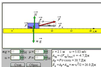
**Задача 2. Механическая работа.** На брусок массой 11 кг действует внешняя сила 450 Н под углом  $25^\circ$ . Коэффициент трения о плоскость 0,2. Определите работу внешней силы после прохождения пути 15 м. Убедитесь в компьютерном эксперименте, что сумма работ силы трения и внешней силы равна кинетической энергии бруска (см. рисунок выше).
