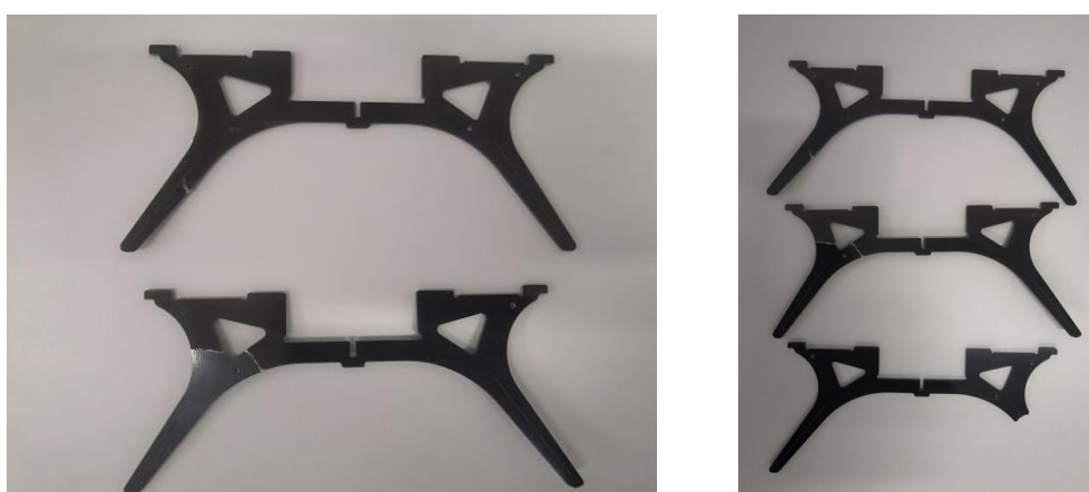
Рисунок 2 – Общий вид исходных опор шасси квадрокоптера Geoscan Pioneer с повреждениями
