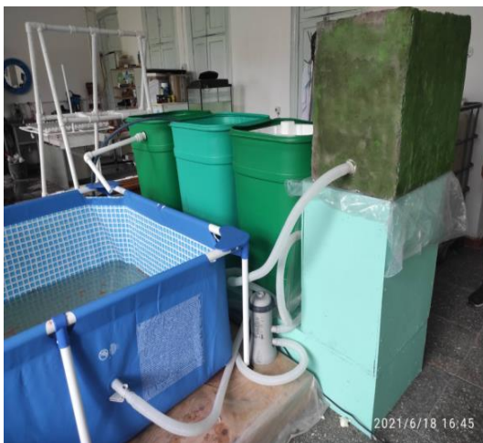
Рисунок 4 – Соединение узлов биофильтра
