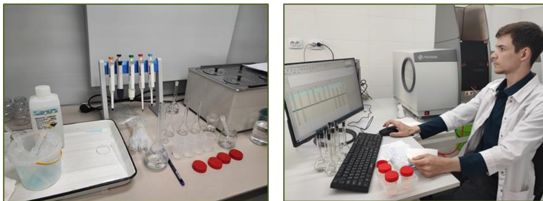
Рисунок 9 – Пробоподготовка ЛРС, почвенных образцов и определение тяжелых металлов на ААС PERSEE A3F в лаборатории лекарственных трав
