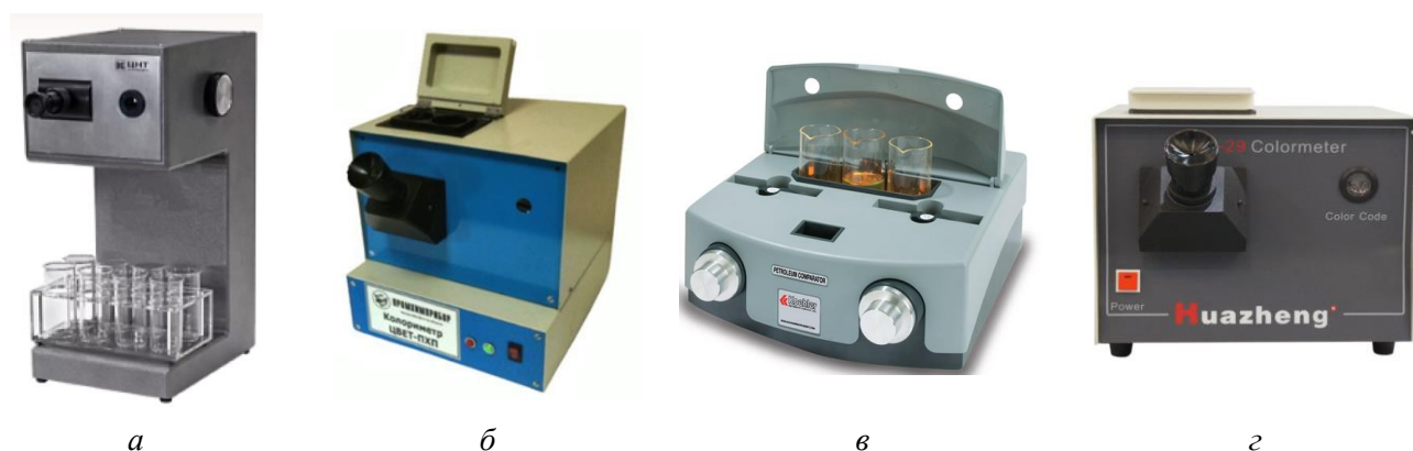
Рисунок 1 – Колориметры: a – ЦНТ; б – Цвет-ПХП; в – Koehler Instrument K13290 ; г – Huazheng Electric HZSD-29
