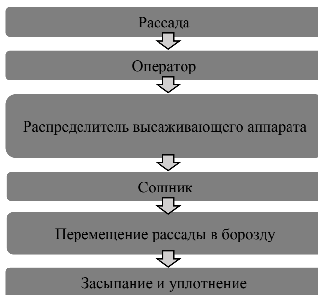
Рисунок 2 – Технологическая схема высадки рассады в грунт.
