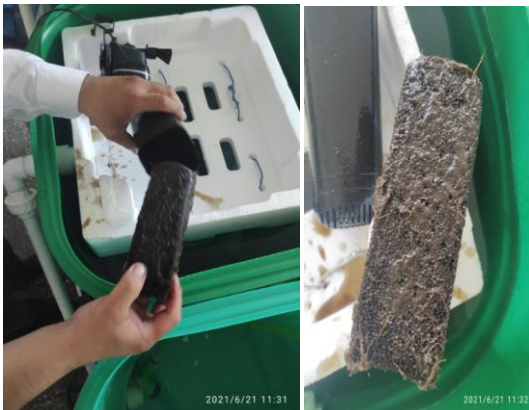
Рисунок 6 – Посев нитрофицирующих бактерий в биофильтр
