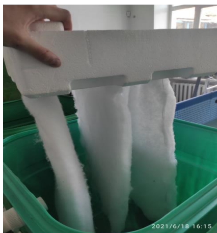
Рисунок 5 - Синтепон в качестве субстрата для нитрофицирующих бактерий в биофильтре для мини-УЗВ
