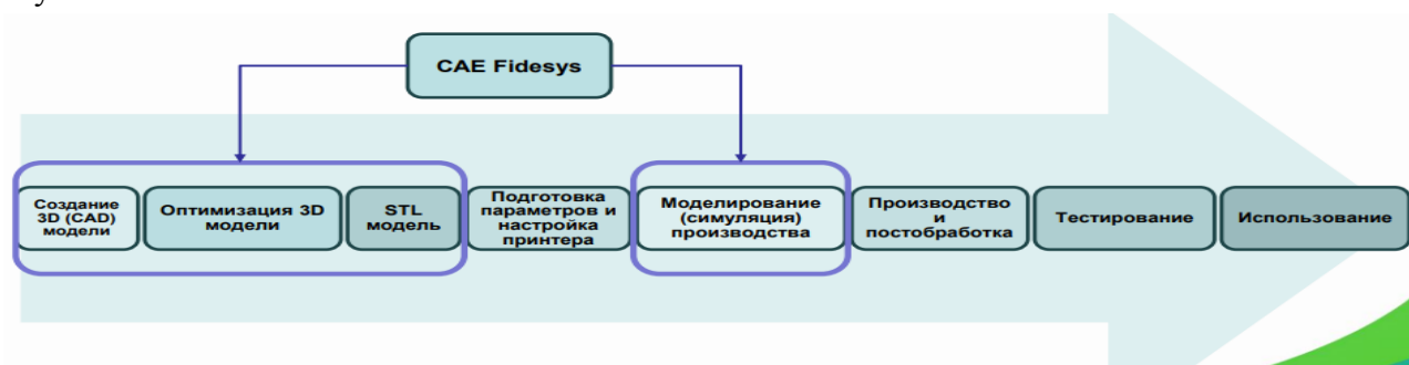
Рисунок 3 -Место FIDESYS в цепочке аддитивного производства [3]
