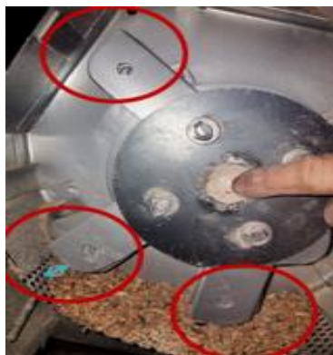
Рисунок 1 - Условная схема работы и характер износа серийных молотков
