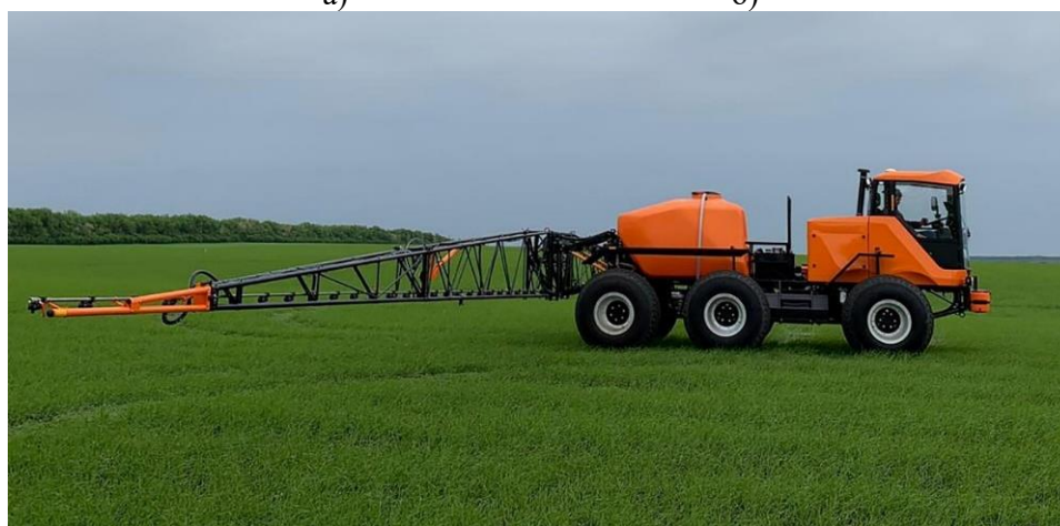
Рисунок 3 - Многофункциональный агрохимический комплекс «Туман-3» (третьего поколения) производства ООО «Пегас-Агро»: а)-разбрасыватель твердых минеральных удобрений; б)-мультиинжектор; в)-опрыскиватель.
