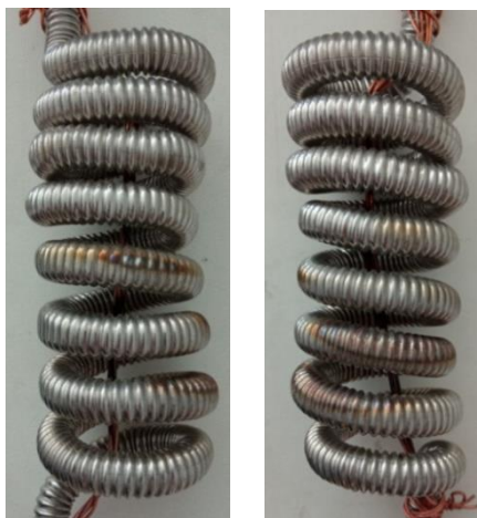
Рисунок 1 – Неравномерный нагрев змеевикового теплообменника
