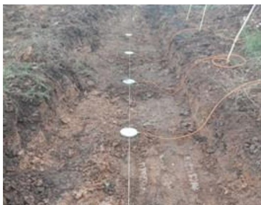
Рисунок 2 – Установка датчиков давления в почве на глубину 0,2 м
