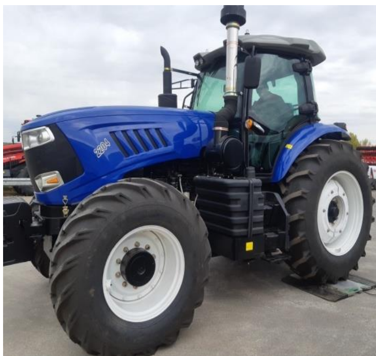
Рисунок 1- Измерение нагрузки, приходящий на заднюю ось трактора TAIHONG TH 2204
